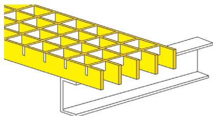
Полосы, несущие нагрузку, должны опираться двумя концами на опору.
