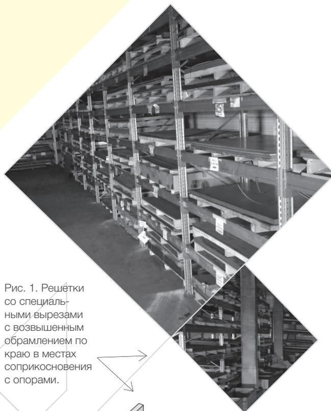
Рис. 1. Решетки со специальными вырезами с возвышенным обрамлением по краю в местах соприкосновения с опорами.
