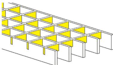
Связующая полоса фиксирует положение несущих полос, нагрузку не несёт.
