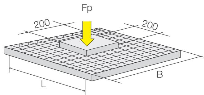
Представленные нагрузки рассчитаны на основании максимально допустимых значений несущей способности для стали S235JR (аналог марки Ст3 ГОСТ 380-94) с шагом по несущей полосе 33 мм. Сосредоточенная нагрузка рассчитана на основании давления груза площадью поверхности 200 x 200 мм.
