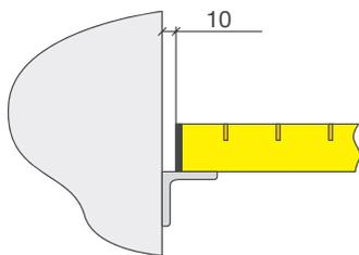
Элементы настила следует располагать в 10 мм от края несущего элемента.
