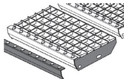
Противоскользящий кант приварен к внешней части ступеней. Он предотвращает возможность поскользнуться. Боковые накладки с отверстиями служат для крепления ступеней при помощи болтов к косоурам.
