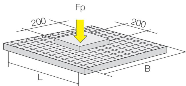
Представленные нагрузки рассчитаны на основании максимально допустимых значений несущей способности для стали S235JR (аналог марки Ст3 ГОСТ 380-94) с шагом по несущей полосе 34 мм. Сосредоточенная нагрузка рассчитана на основании давления груза площадью поверхности 200 x 200 мм.
