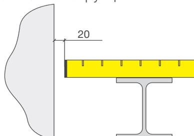
Если на конструкции, вдоль границы раскладки решётчатого настила есть низко расположенные выступающие элементы, то раскладка делается до них с зазором в 10 мм.
