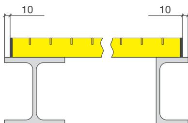
При установке настила в различные ниши или уголки необходимо оставлять зазор 5 мм с каждой стороны.
