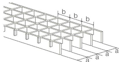
Размеры ячеек по осям обозначаются двумя цифрами:  $a$  - расстояние между несущими;  $b$  - расстояние связующими полосами.
