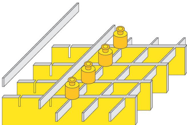
Рис. 1. Изготовление прессованного решетчатого настила (P). Запрессовка покрывных полос в несущие полосы под давлением в 5000 kN (около 500 тонн).
